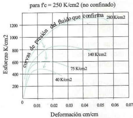
Fig 1.8 Curvas Esfuerzo - Deformación Cilindros a compresión Triaxial
