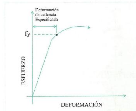
Fig. 1.18 Punto de cedencia para un acero sin plataforma de cedencia bien definido
